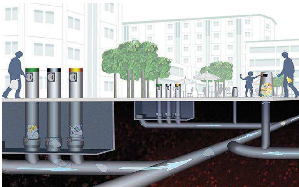
Рис. 1 – Модель пневматической системы удаления отходов [5] Fig. 1 – Model of pneumatic waste disposal system [5]
