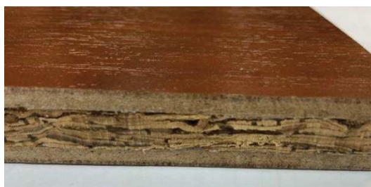
Рис. 1 – Трехслойный древесный материал с наружными слоями из древесноволокнистой плиты и внутренним слоем из бересты
