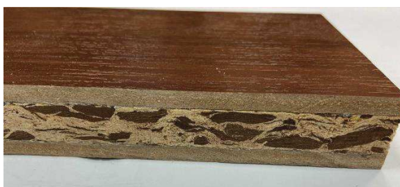
Рис. 2 – Трехслойный древесный материал с наружными слоями из древесноволокнистой плиты и внутренним слоем из плиты на основе сосновой коры и стружки
