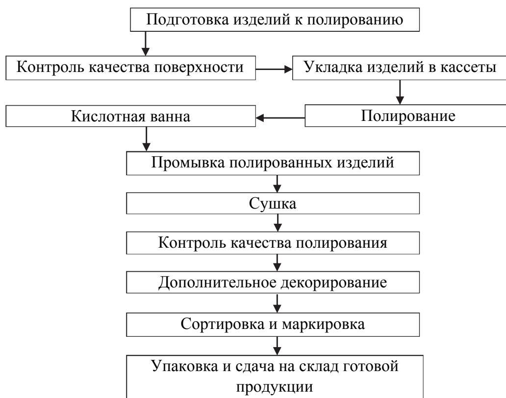
Рис. 3.45. Технологическая схема химического полирования сортовых изделий
