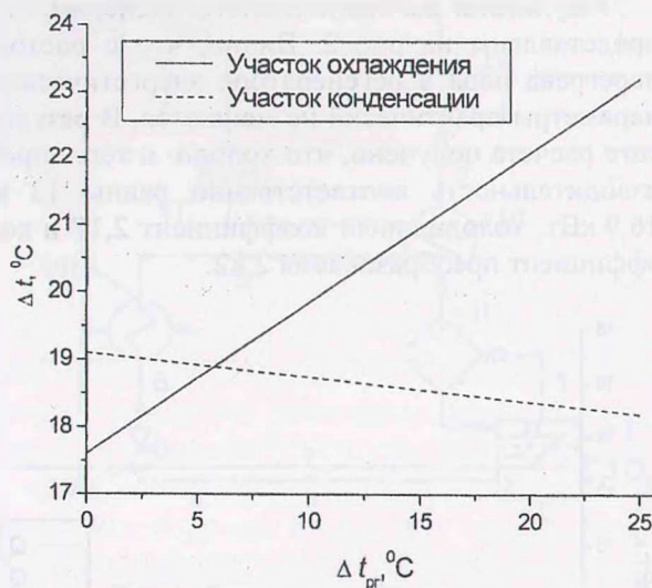
Рис. 6. Изменение температурных напоров на участках конденсатора
