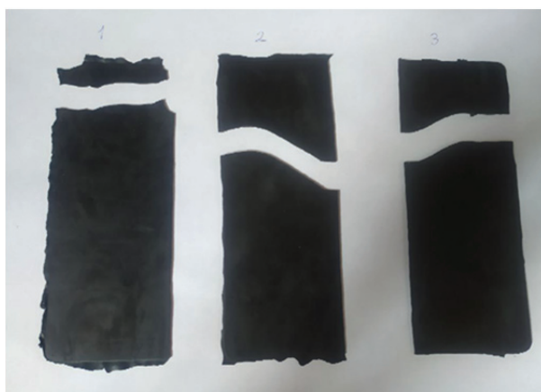
Рисунок 1 – Разрыв эластомеров, облученных рентгеновским излучением с различной мощностью экспозиционной дозы рентгеновского излучения: 1 – контрольный образец (0 кР/ч); 2 – 50 кР/ч, 3 – 100 кР/ч
