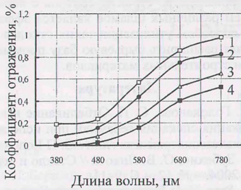
Рис. 1. Кривые спектрального отражения образцов на основе глины и шламов, обожженных при температуре 1050 °С: 1 – шлама ДФЗ; 2 – без добавок; 3 – 10 % гальванического шлама МТЗ; 4 – 40 % гальванического шлама МТЗ
