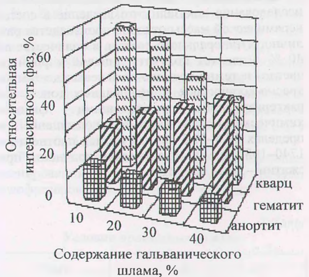
Рис. 4. Зависимость фазообразования при температуре 1050 °С от содержания шлама МТЗ
