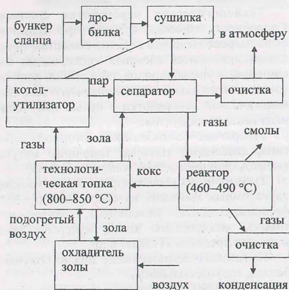
Рисунок. Технологическая схема установки термического разложения сланца
