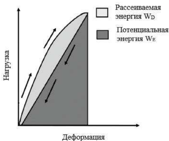
Рис. 2 - Схематическая диаграмма цикла разгрузки-загрузки, показывающая количество рассеиваемой энергии.
