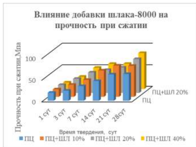
Рисунок 3 – Влияние концентрации шлака на прочность при сжатии
