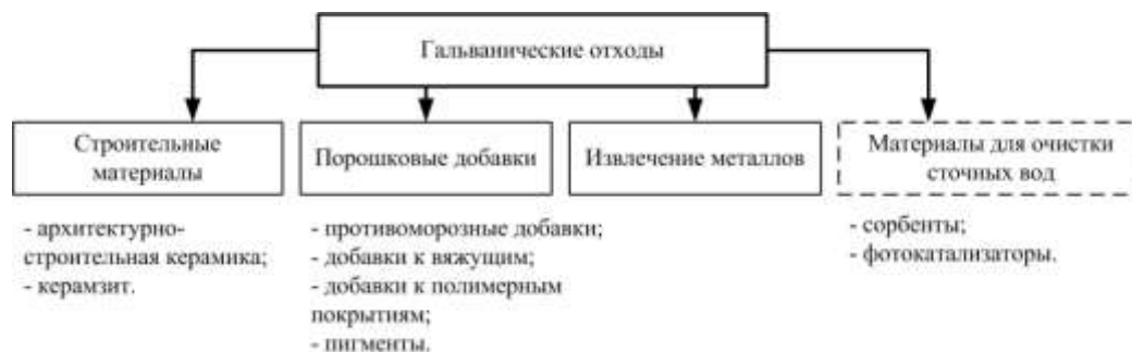
Рисунок 1. – Перспективные направления использования отходов гальванических производств
