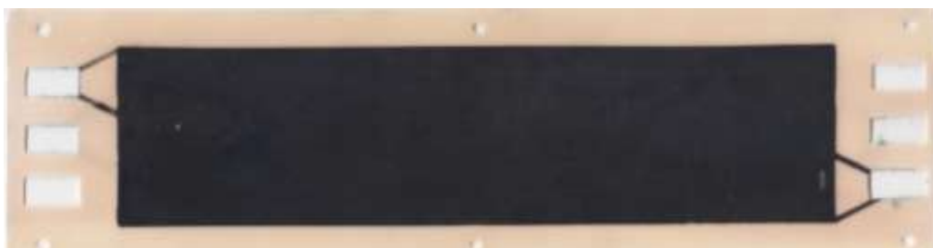
Рисунок 2. Катионообменная мембрана модифицированная полианилином
