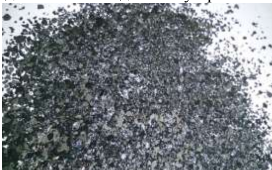
Рисунок 5. – Полученный диоксид марганца \gamma - модификации
