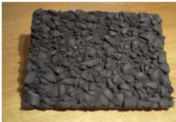
Рис. 3. Изготовленная пеносиликатная плитка с наполнителем из шунгитового порошка.
