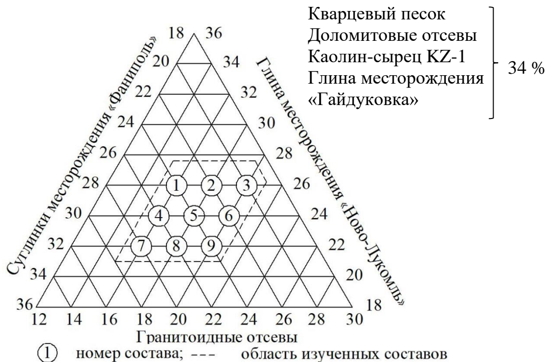
Рис. 1 – Область составов керамических масс для плиток внутренней облицовки стен
