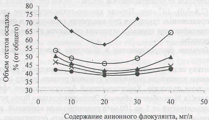
Рис. 2. Зависимость объема отстоя осадка от рецептуры флокулянтов. Содержание флокулянтов: анионного – 20 мг/л; катионного – \blacklozenge – 5 мг/л; \circ – 10 мг/л; \blacktriangle – 15 мг/л; \times – 20 мг/л; \bullet – 25 мг/л
