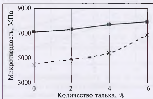
Рис. 3. Микротвердость образцов с необработанной (■) и шлифованной (x) поверхностью
