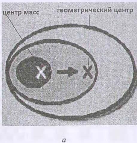
Рисунок 3 — Модель «геометрический центр–центр масс» как пример учета неоднородностей: а – классическая модель; б – модель неоднородностей на поверхности бумаги Fig. 3 — Model “geometric center–mass center” as an example of taking into account unhomogeneities: а – classical model; б – model of unhomogeneities on the paper surface
