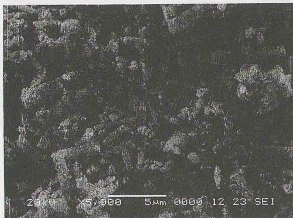
Рис. 4. Электронно-микроскопическая фотография порошка ксерогеля, соответствующего составу \text{Ba}_{0,998}\text{La}_{0,002}\text{TiO}_3 , прошедшего термообработку при температуре 900°C
