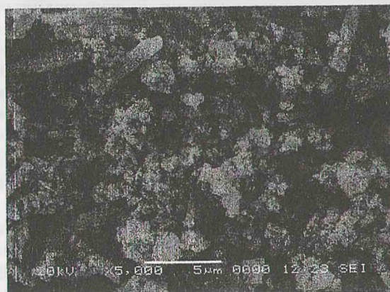
Рис. 3. Электронно-микроскопическая фотография порошка ксерогеля, соответствующего составу \text{BaTi}_{0,998}\text{W}_{0,002}\text{O}_3 , прошедшего термообработку при температуре 900°C
