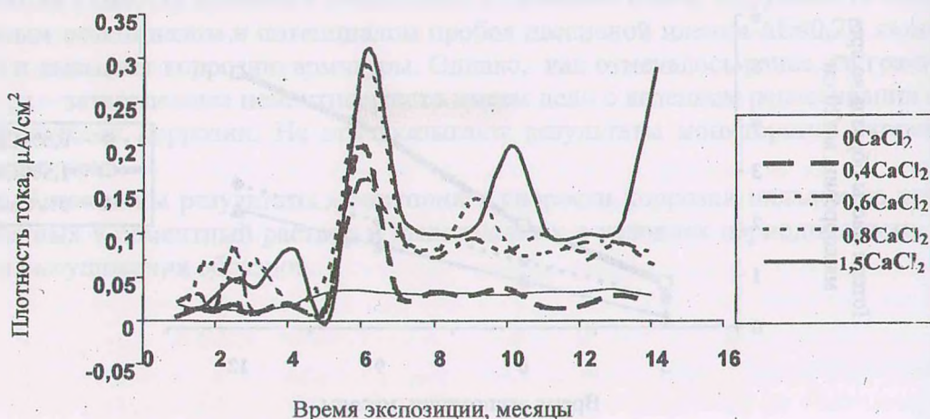
Рис. 7. Результаты мониторинга скорости коррозии электродов из стали St3S во время экспозиции в камере с \text{CO}_2 (растворы с разным содержанием \text{CaCl}_2 )
