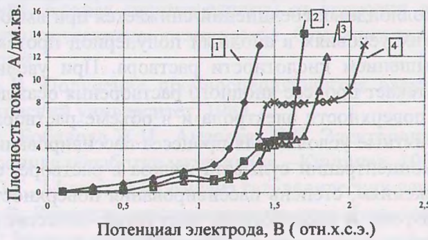
Рис. 1. Влияние добавки лимонной кислоты на катодный процесс. Концентрация лимонной кислоты, г/л: 1 – без добавки лимонной кислоты; 2 – 5; 3 – 8; 4 – 12
