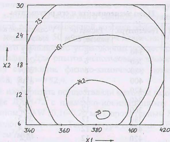
Рис. 2. Двумерное сечение поверхности отклика изменения выхода аллооцимена (%) в зависимости от условий термической изомеризации  $\alpha$ -пинена: X1-температура,  $^{\circ}\text{C}$ ; X2-расход  $\alpha$ -пинена,  $\text{см}^3/\text{ч}$
