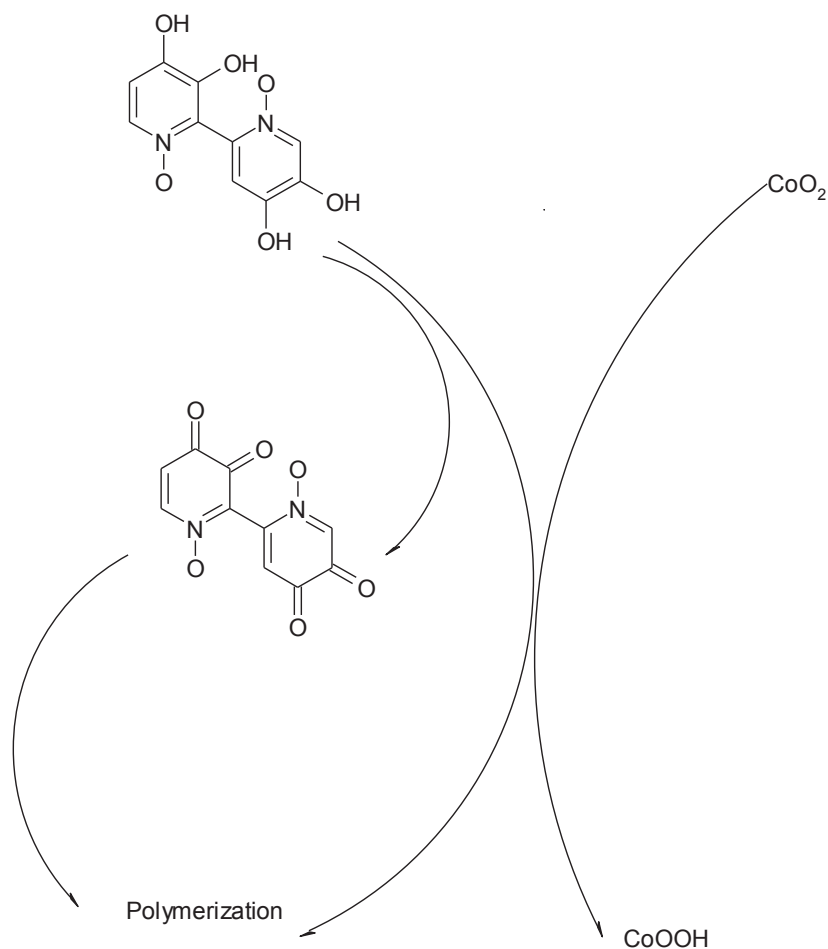
Рис.2. Схема электрохимического определения орелянина на электроде, модифицированном сквараиновым красителем и оксигидроокисью кобальта
