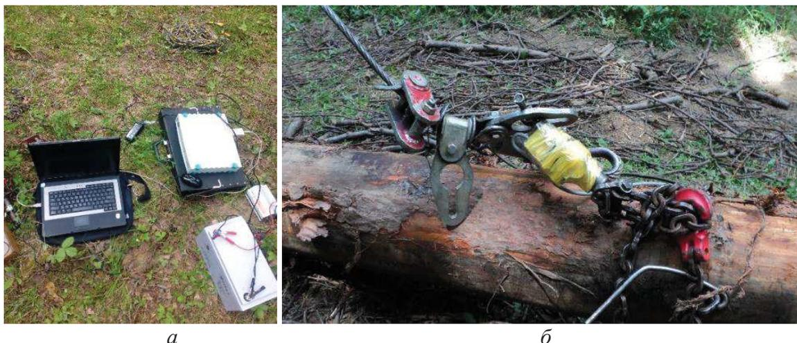
*a* – измерительное оборудование (ноутбук, Spider8, аккумулятор); *б* – датчик силы HBM U9B
