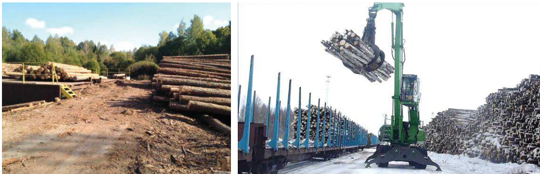
Рисунок 3 – Накопление процесс на складе и погрузка сортиментов в вагоны
