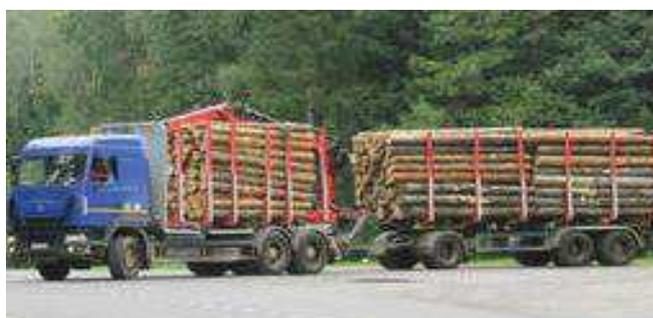
**Рисунок 3 – Автомобиль-сортиментовоз с трехосным прицепом**
