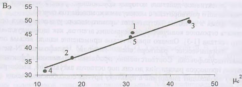
Рис. Зависимость между параметрами  $\mu_c^2$  и  $B_э$ : 1 – диметилсульфоксид–диметилсульфоксид; 2 – триэтиленгликоль–триэтиленгликоль; 3 – сульфолан–сульфолан; 4 – триэтиленгликоль–этанол; 5 – триэтиленгликоль–сульфолан
