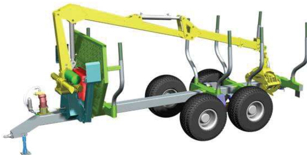
Рисунок 4 – Лесовозный полуприцеп ПЛ-10 с гидроманипулятором ГМ-42Т
