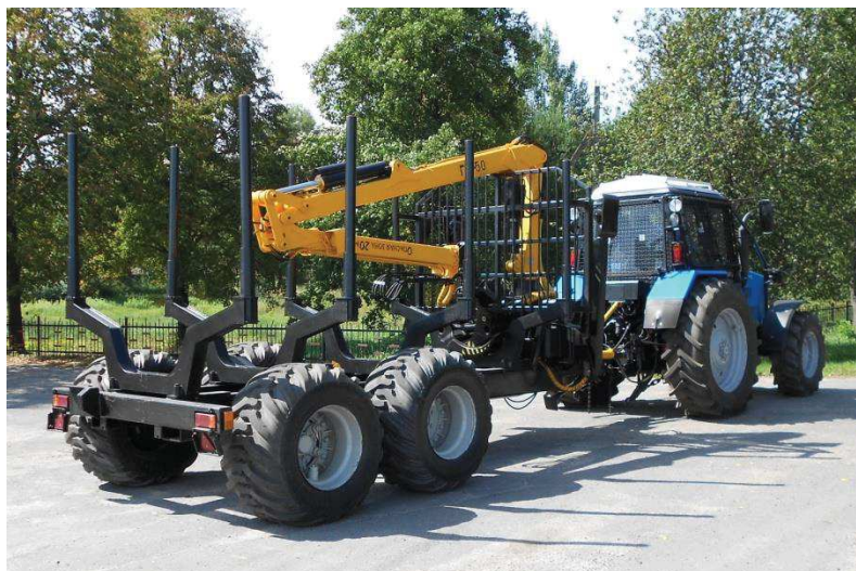
Рисунок 3 – Лесовозный полуприцеп ПМ-10 с гидроманипулятором ГМ-50-04
