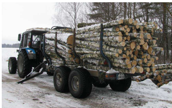
Рисунок 2 – Лесовозный полуприцеп ПЛ-9-02 с гидроманипулятором PALMS 665
