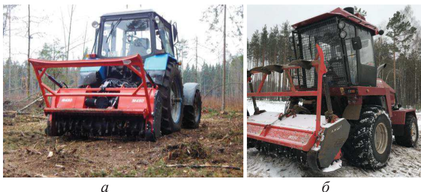
Рисунок 2 – Агрегатирование мульчеров АНWI М450m-1900 ( а ) и М550m-2410 ( б ) на базовое шасси BELARUS-1221В.2 и универсального энергетического средства УЭС-2-280А «ПАЛЕССЕ 2U280А» соответственно
