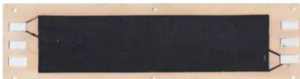
Рисунок 2. Катионообменная мембрана модифицированная полианилином
