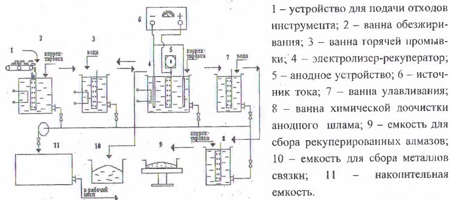
Рисунок 8 – Технологическая схема электрохимической рекуперации алмазов и металлов из отходов алмазно-абразивного инструмента
