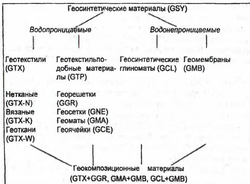
Рис. Схема классификации геосинтетических материалов
