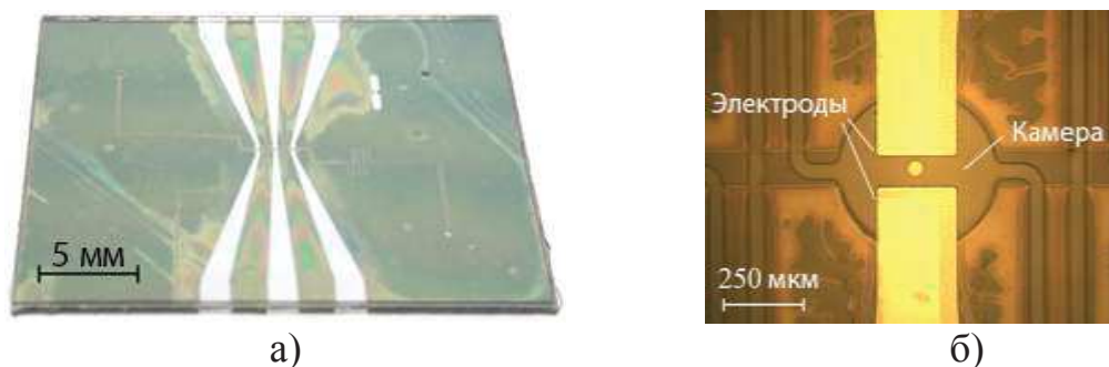
Рисунок 4 - Изготовленный микронасос: а – общий вид, б – актюатор, вид сверху
