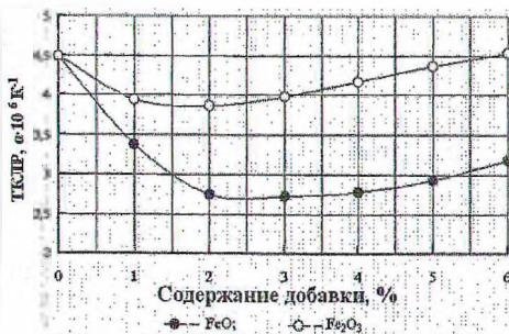
Рисунок 6 – Зависимость ТКЛР материала от содержания добавки (температура обжига 1200 °С)
