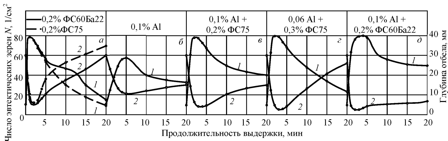
Рис. 5 – Влияние продолжительности выдержки расплава при температуре 1400°C на число эвтектических зерен (1) и глубину отбела (2) чугуна, модифицированного 0,2% ФС75, 0,2% ФС60Ба22 (а), 0,1%Al (б), 0,1%Al+0,2%ФС75 (в), 0,06%Al+0,3%ФС75 (г) и 0,1%Al+0,2%ФС60Ба22 (д)
