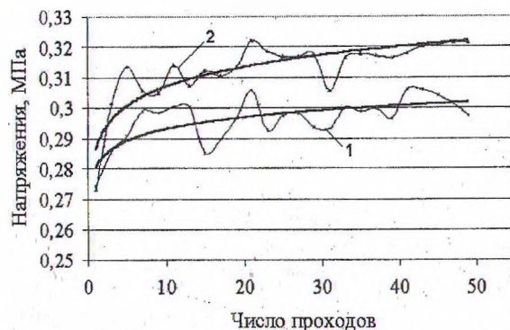
Рис. 3. Зависимость вертикальных напряжений в грунтовом основании от скорости движения тележки: 1 – скорость 0,6 м/с; 2 – скорость 0,3 м/с
