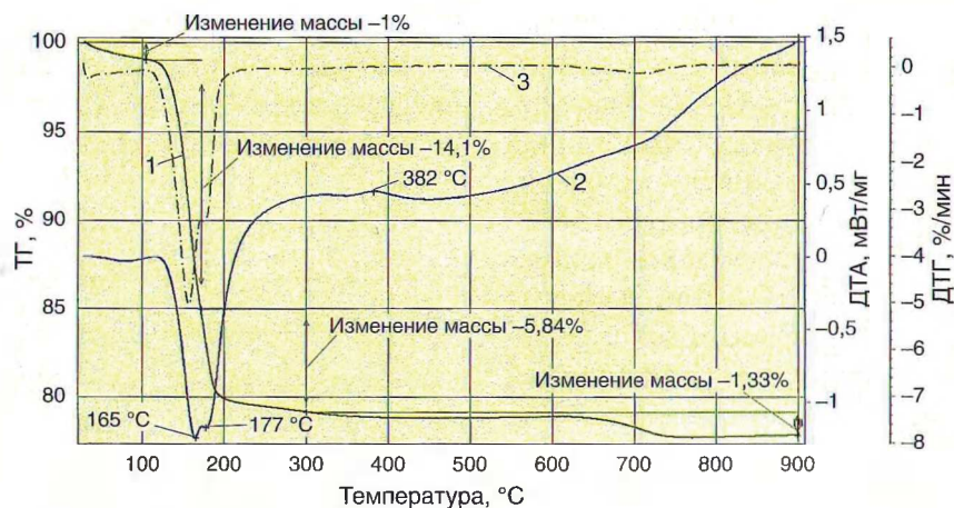
Рис. 3. Термический анализ полученного гипса
