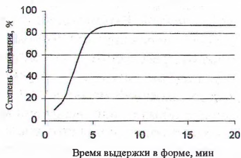
Рис. 2. Зависимость степени сшивания полимера в КДП от времени выдержки в форме
