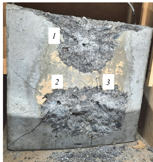
Рис. 13. Фото испытываемого образца: 1, 2, 3 – места внедрения трех пуль в образец
