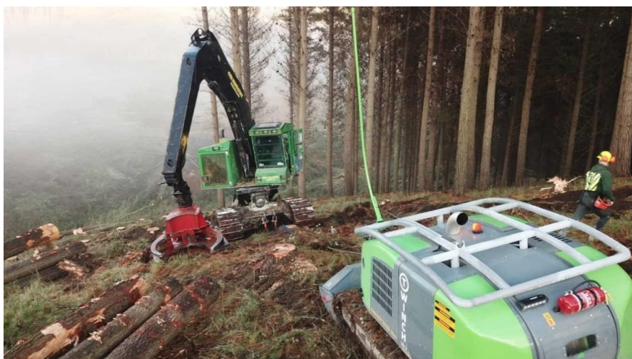
Рисунок 2 – Валочно-пакетирующая машина с лебедкой T-Winch
