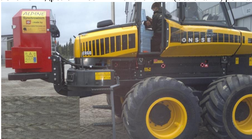
Рисунок 1 – Харвестер Ponsse Ergo с лебедкой Synchronwinch
