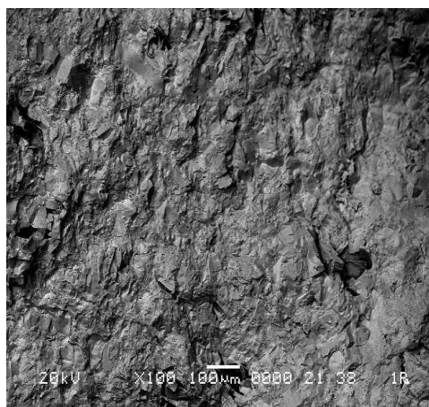
Рисунок 4 – Общий вид литого электротермофосфорного шлака, увеличение в 100 раз
