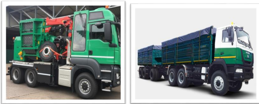
Рисунок 3 – Рубильный комплекс МАЗ-МАН 636559 и автопоезд-щеповоз «МАЗ-МАН»
