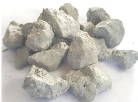
Рисунок 3 – Общий вид литого электротермофосфорного шлака
