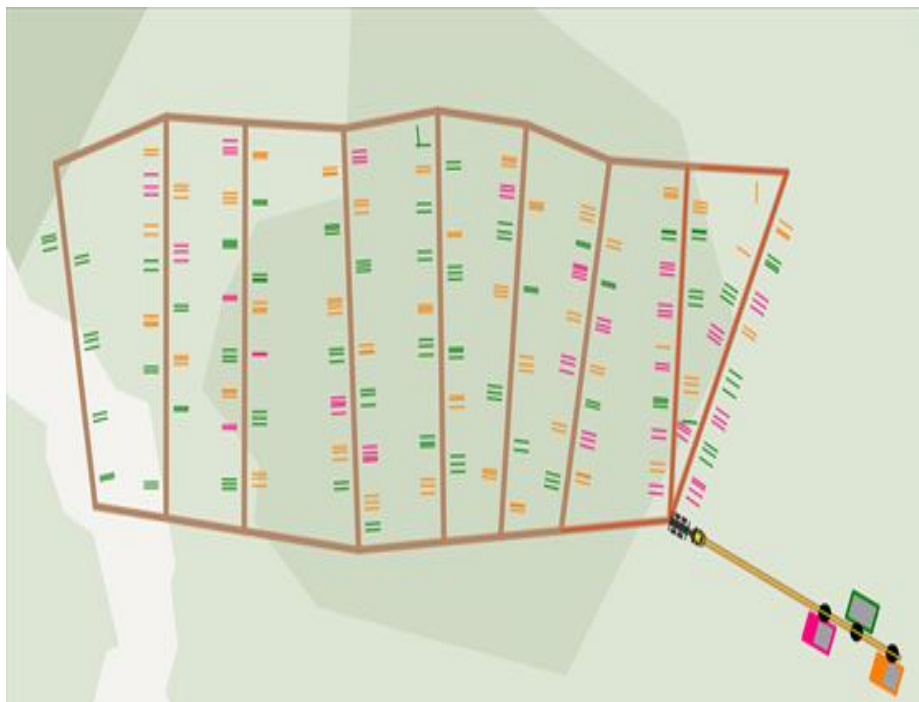
Рисунок 3 – Схема трелевки, воспроизведенная в программе Ponsse ForwarderGame
