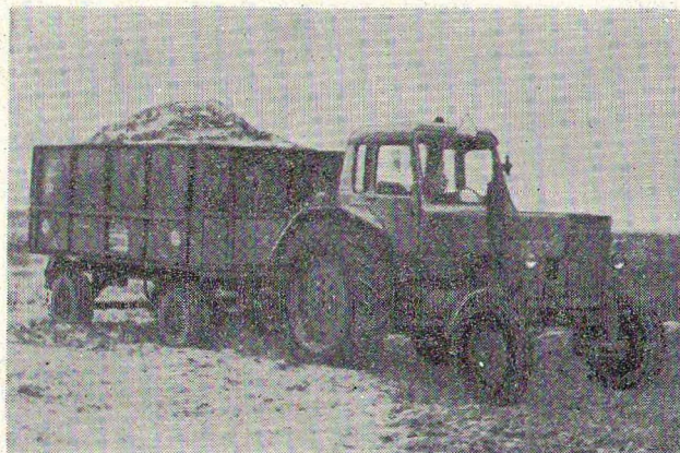
Рис. 4. Транспортировка щепы трактором ТМЗ-80 с прицепом ПСЕ-12,5
