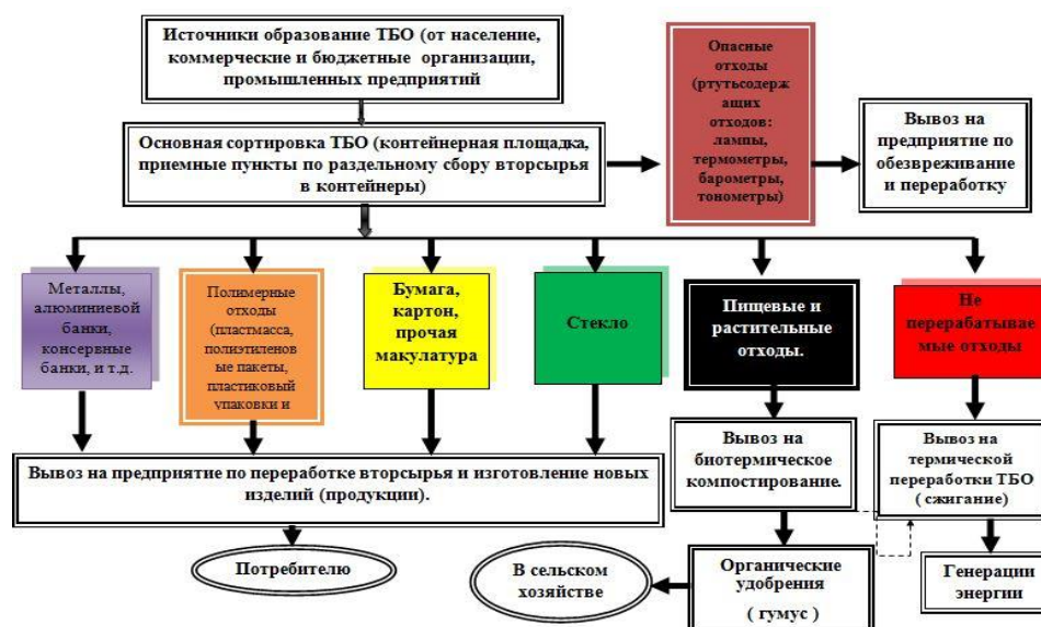
Рисунок 1 - Схема комплексной системы сбора и сортировки ТБО (вторсырья) на переработку на примере управления ТБО г. Душанбе
