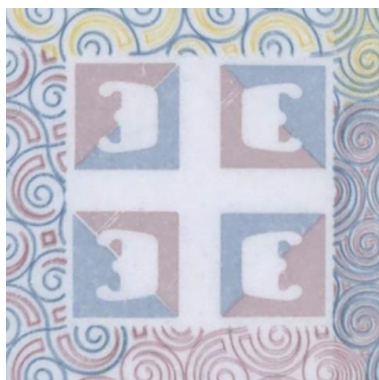
Рисунок 3 – Совмещающееся изображение. Вид в проходящем свете. Элементы на лицевой и оборотной стороне совмещены и образуют цельное по сюжету изображение без пробелов, накладок и сдвигов (паспорт Сербии, 2008 год)
