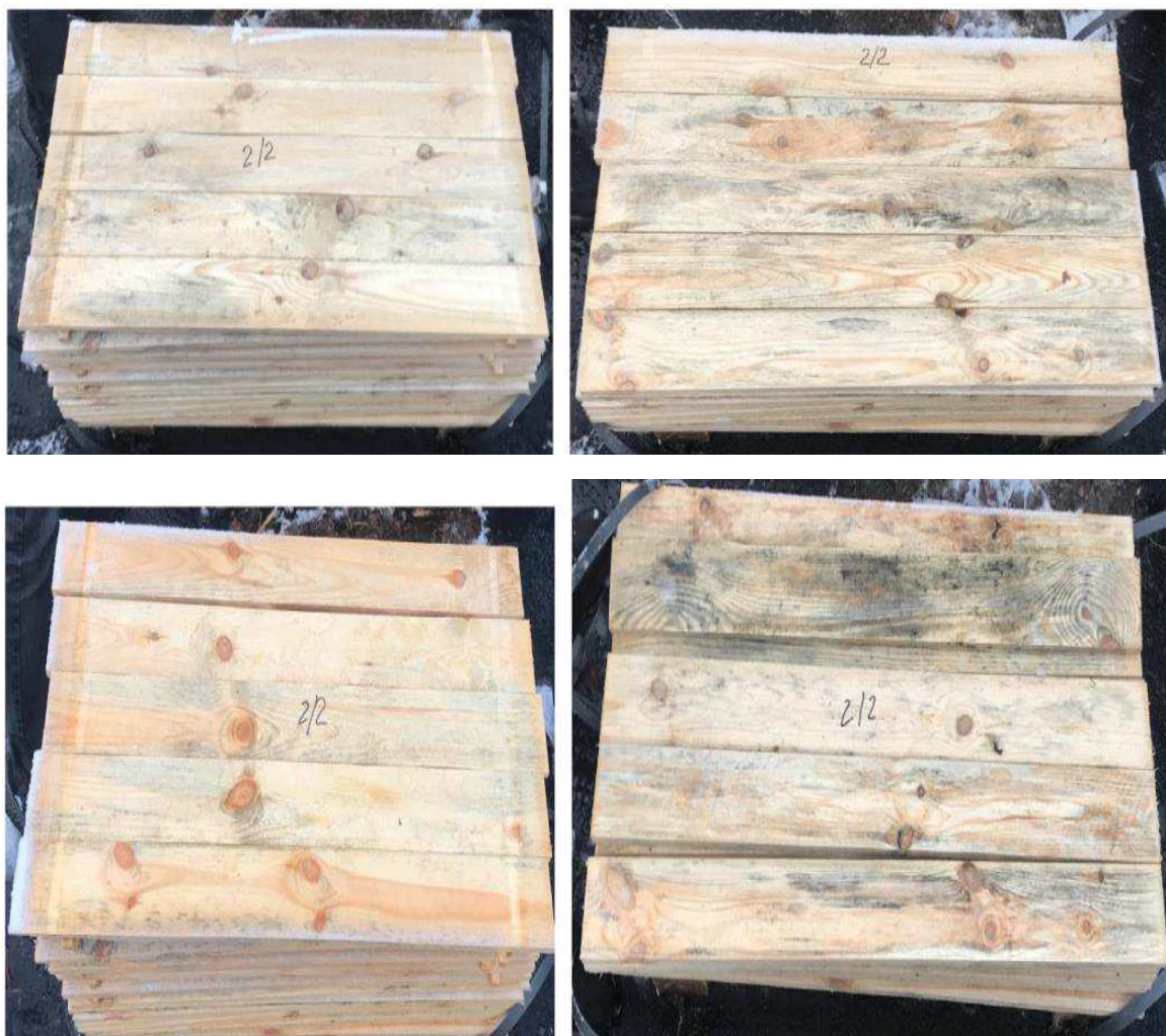
Рисунок 2 – Образцы через 3 месяца после начала проведения испытаний
