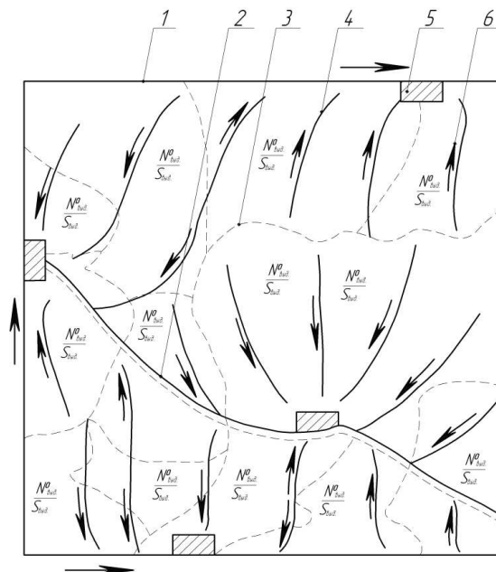
1 – квартальная просека; 2 – лесохозяйственная дорога; 3 – граница выдела; 4 – трелевочные волоки; 5 – промежуточные склады; 6 – направление трелевки (подвозки) лесоматериалов Рисунок 2 – Схема технологического устройства квартала (группы лесосек)
