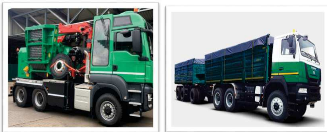
Рисунок 3 – Рубильный комплекс МАЗ-МАН 636559 и автопоезд-щеповоз «МАЗ-МАН»
