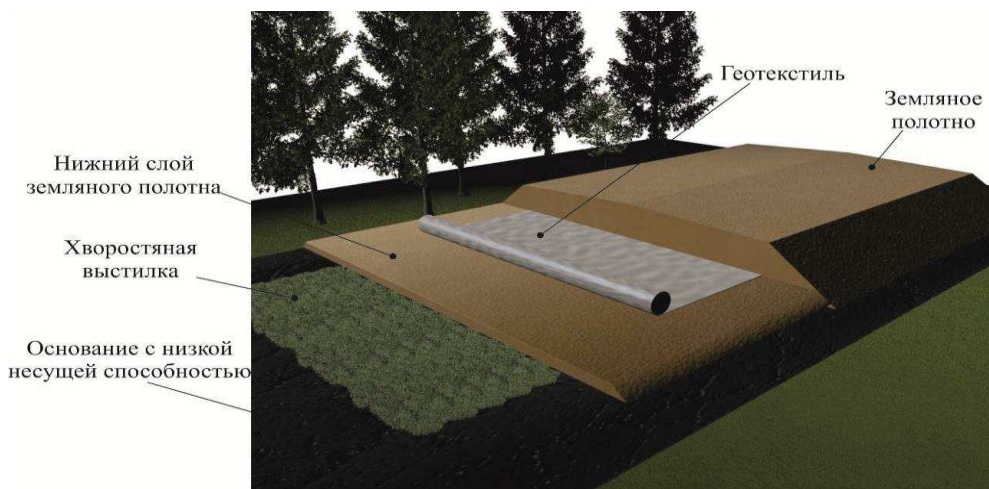
Рисунок 4 – Конструкции с использованием геосинтетического материала
