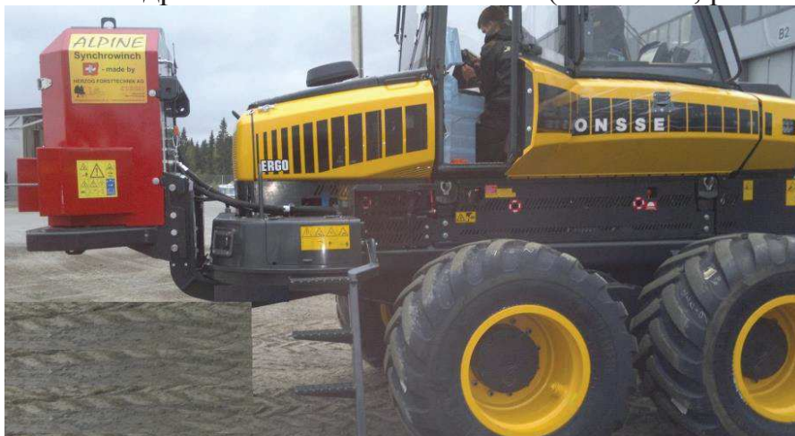
Рисунок 1 – Харвестер Ponsse Ergo с лебедкой Synchronwinch
