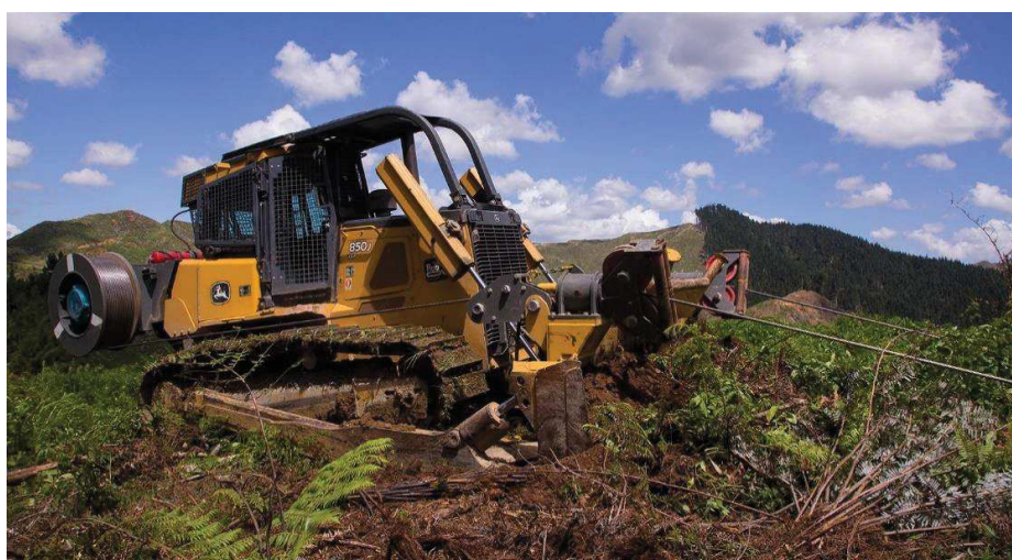
Рисунок 3 – Бульдозер с дистанционным управлением (ROB) для вырубki крутых склонов
