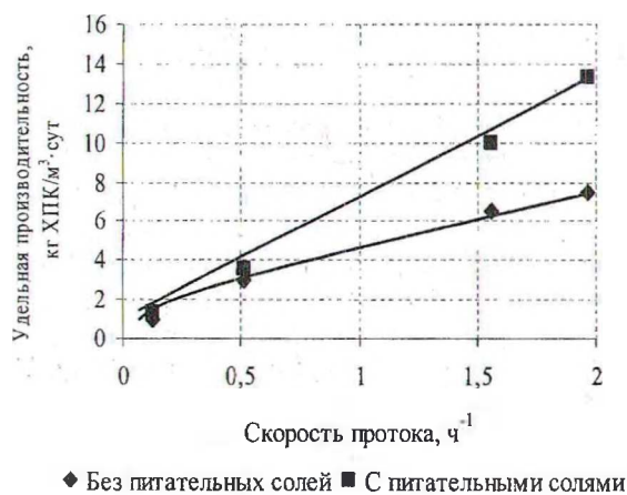
Рис. 3. Эффективность очистки сточной воды (а) и удельная производительность по деструктированным загрязнениям (б) биосорбера с псевдооживленным слоем сорбента в анаэробных условиях
