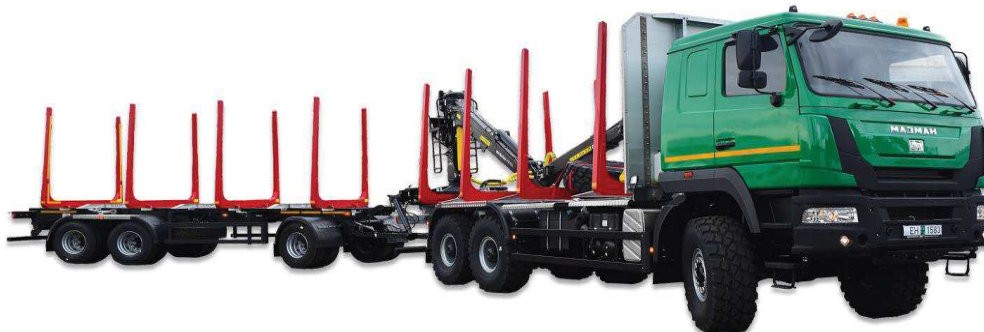
Рисунок 1 – Автомобиль МАЗМАН 736559 с колесной формулой 6х6 и прицепа МАЗ-МАН 890001 для вывозки древесного сырья с верхнего или промежуточного лесопромышленного склад
