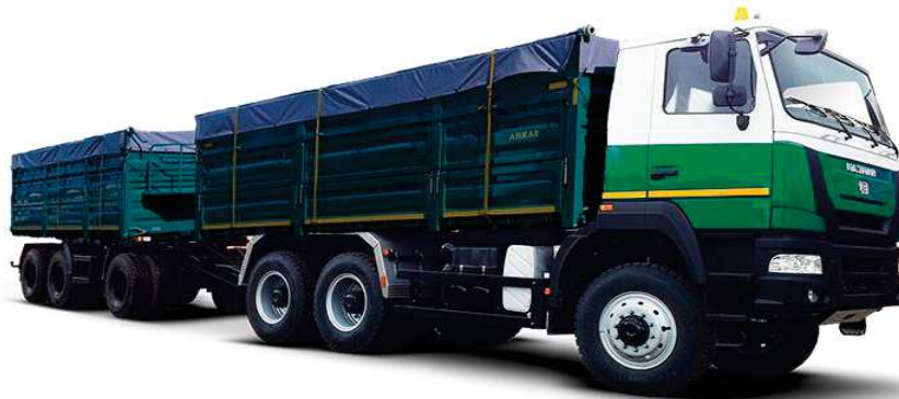
Рисунок 2 – Автомобиль MAZ-MAN 652559 и прицепа MAZ-MAN 890002 для перевозки щепы
