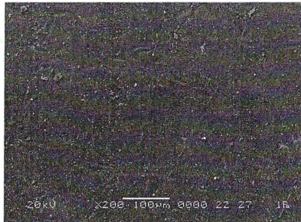
Рис. 3. SEM-изображение поверхности резины, модифицированной C^+
