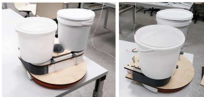
**Рисунок 2 – Экспериментальная сеялка в процессе сборки**
