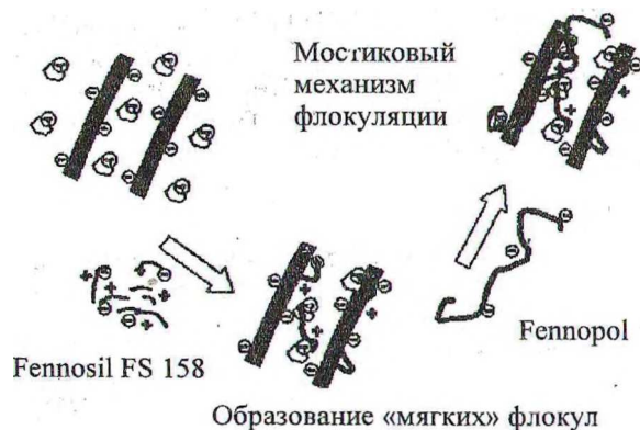
Рис. 1. Механизм действия двойной системы удержания Fennosil A
