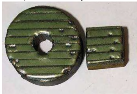
Рисунок 1 – фото экспериментальных образцов ПГ-СР4 (без наноуглеродных компонентов) после лазерного оплавления
