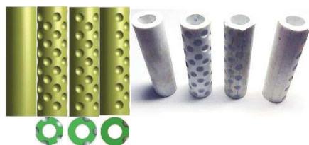
Рис.1. Размеры цилиндров с системами выемок
